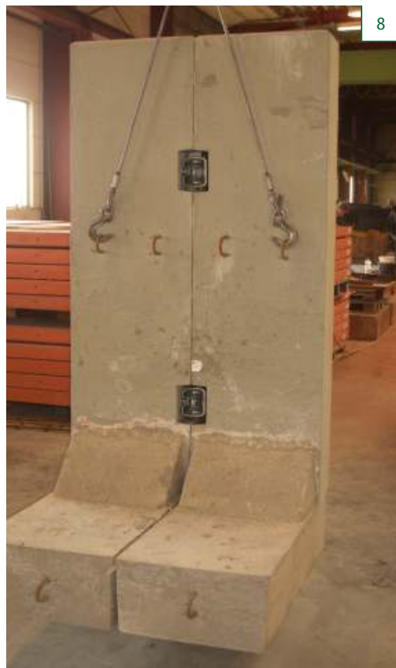
Assemblage de parois portantes coudees
